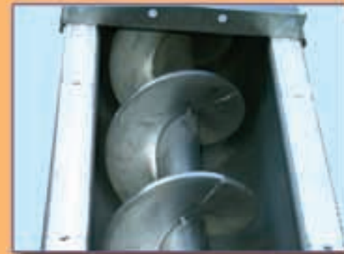
Extra-heavy-duty flight Schneckenflügel in schwerer Ausführung Spires extra-lourdes Eliche extrapesanti
