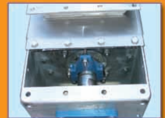
High quality seal and split gland Qualitätsabdichtung und geteilte Stopfbuchsenbrille Étanchéité d'haute qualité et presse-étoupe sectionnée Tenuta ad alta qualità con premibaderna sezionata
